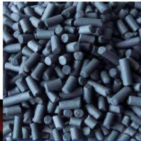
In verschiedenen Einsatzgebieten wie bei der Herstellung von Trinkwasser, bei der Lebensmittelherstellung, in der chemischen Industrie sowie zur Behandlung von Abwasser und Reinigung verschiedenster Arten von Abluft, wird Aktivkohle in sogenannten Festbettfiltern als eine sehr wirksame Lösung zur Entfernung von unerwünschten Schadstoffen eingesetzt.
