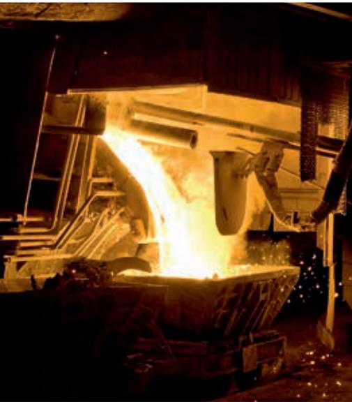
In Landeck fällt bei der Karbidproduktion Kohlenmonoxid an, das zum Heizen verwendet wird.
