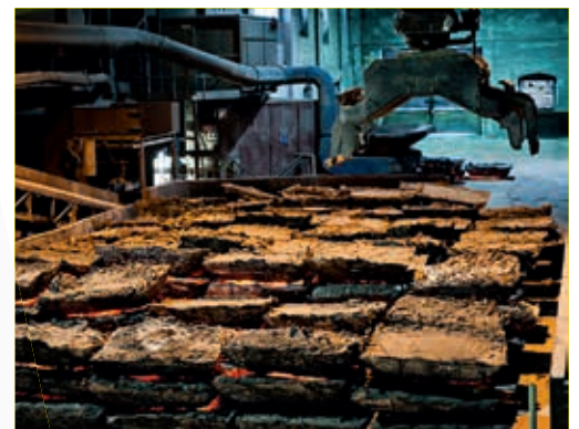
Die Karbidblöcke werden zum Kühlen aufgelegt. Nach 24 Stunden haben sie „nur“ noch 120° C und werden weiterverarbeitet.
